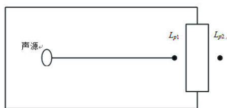
等效室外声源声功率级法示意图
